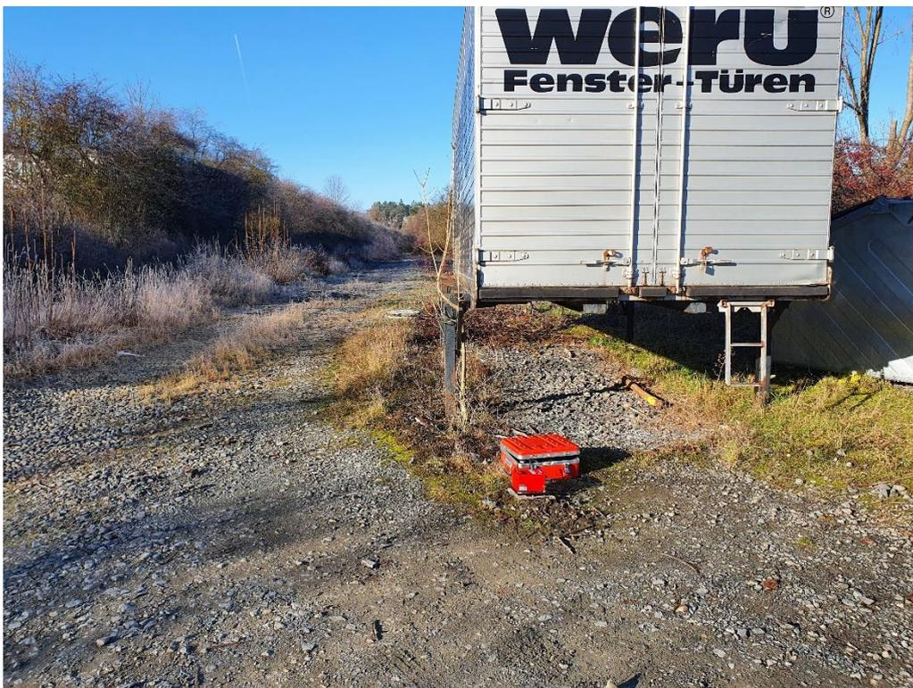
*Abbildung 2: Ankopplung des Schwingungsmesssystems SYS20 am MP1 über einen Erdspeieß an den Boden während des Messtermins vom 23.11.2021 (Entfernung zum Gleis: ca. 10 m)*
