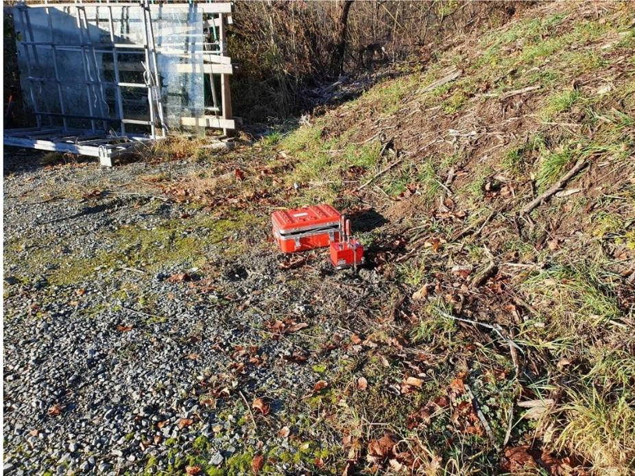
*Abbildung 3: Platzierung des Schwingungsmesssystems SYS19 am MP2 mittels eines Erdspießes während des Messtermins vom 23.11.2021 (Entfernung zum Gleis: ca. 25 m)*
