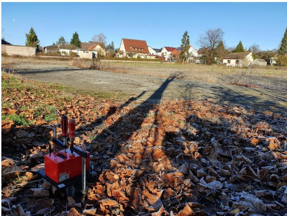
*Abbildung 4: Platzierung des Schwingungsmesssystems SYS18 am MP3 mittels eines Erdspießes auf dem Boden während des Messtermins vom 23.11.2021 (Entfernung zum Gleis: ca. 35 m)*
